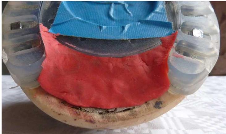
*Abbildung 8: Abdichten des Steges mit Knetgummi o.ä.*
