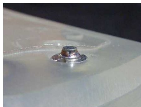
Richtig montiert: nur der Hartmetallstift steht vor...
