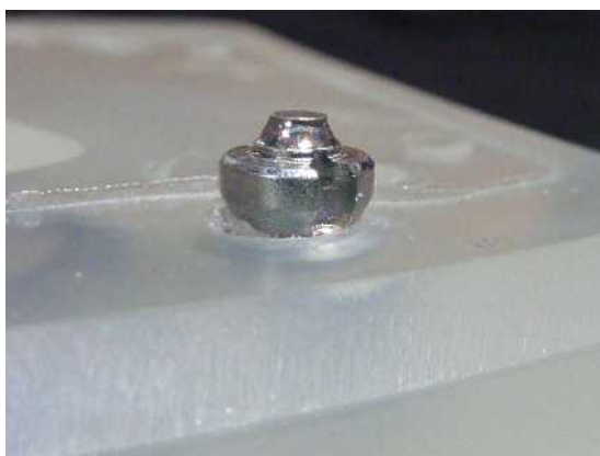
Falsch montiert: der Spike steht viel zu weit über die Beschlagsoberfläche und reisst leicht aus!
